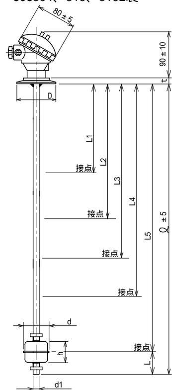
\* 自己保持型リードスイッチ仕様：ステム最下部のストッパ1個とフロート1個で多接点の検出が可能です。
